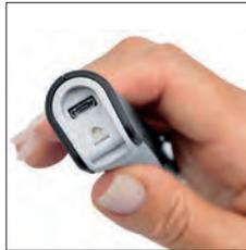
Aufladung über USB-Ladekabel mit Micro-USB-Anschluss
