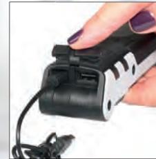
Aufladung über USB-Ladekabel mit Micro-USB-Anschluss
